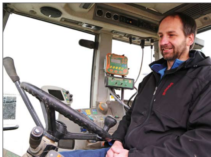
Notwendig war eine „Hand-Bremse“ für den Traktor (großer schwarzer Hebel, links). Der Rest ging vorher schon mit Joystik.
