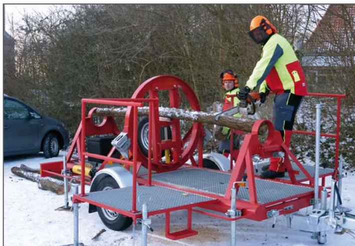
Ein Baumbiegesimulator ermöglicht das sichere Üben mit der Motorkettensäge.
