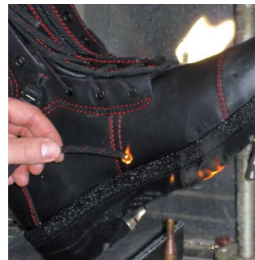
Durchgefallen: Was nicht brennen darf, brennt trotzdem. Feuerwehrtiefel in der „Folterkammer“
