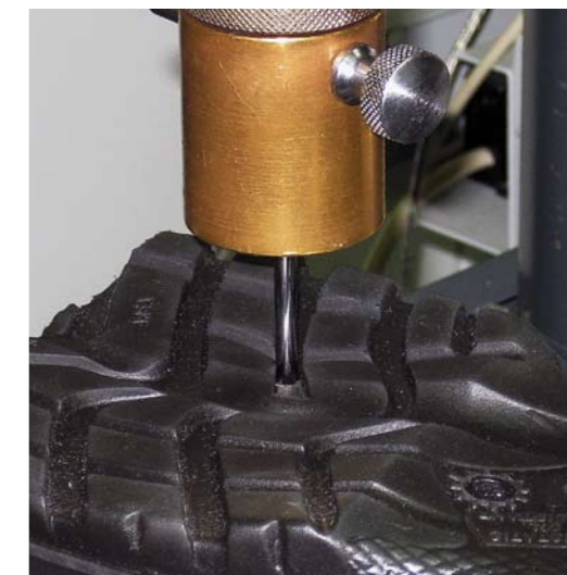
Prüfung auf Durchtrittfestigkeit der Sohle unter Laborbedingungen
